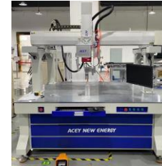
Fig 5: Equipo de soldadura laser para línea BESS.
