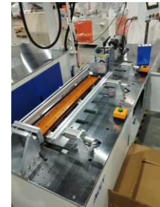
Fig 6: Equipo de compactación de módulos para línea BESS.
