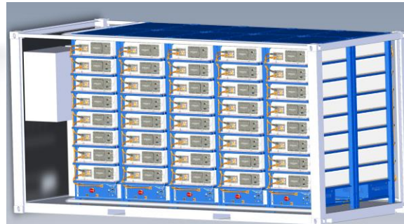
Fig 4. Esquema de edificio contenedor de 5.015 kWh.
