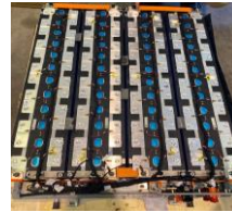
Fig 3: Battery Pack para BESS de 5.015 kWh.
